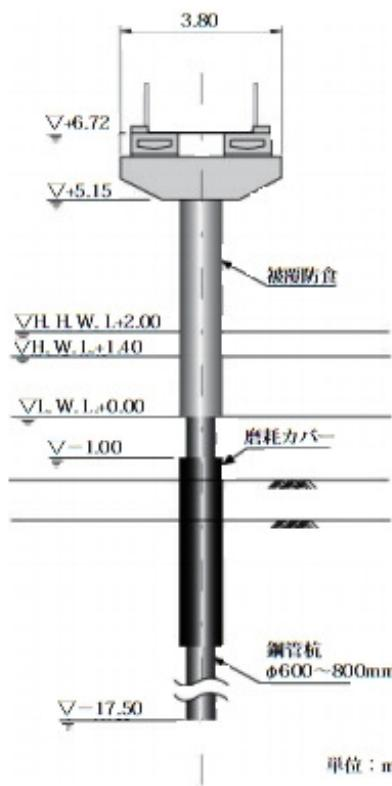
図 2.3 観測桟橋の概要図
